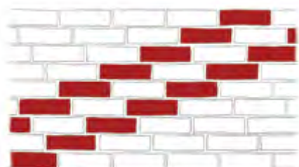
Wiązanie wozówkowe - przesunięcie ukośne o 1/4 cegły
